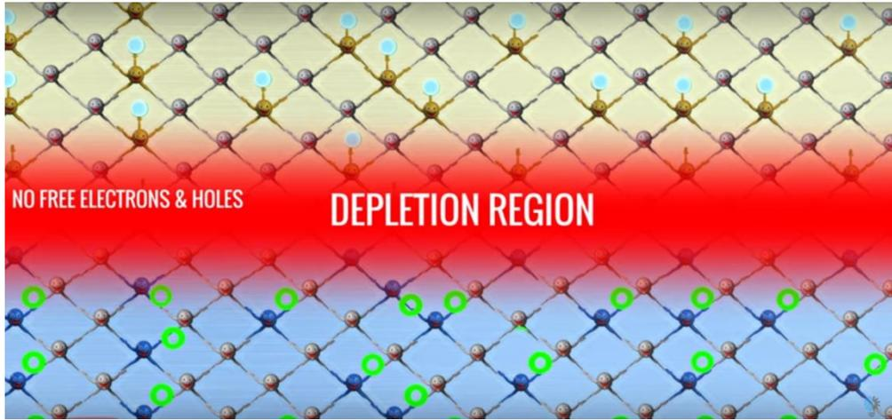
الشكل (١٢) شكل توضيحي يظهر به منطقة النضوب بعد وصلة نوعيتين من السيليكون
