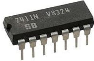
الشكل (٤٠) شكل بوابات (AND) ثلاثية المداخل (7411) ومكوناته الداخلية
